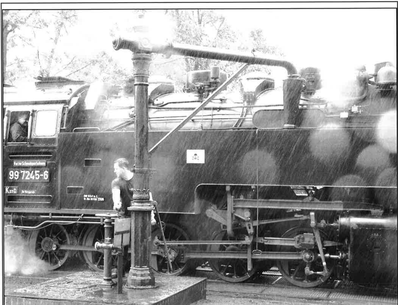
Sous la pluie, l'assistant manoeuvre le robinet d'arrivée d'eau de la pompe à eau pour remplir les soutes de la locomotive 0-5-0 T n°99 7245-6 du chemin de fer à voie métrique "Harzer-Schmalspurbahnen" (photo Michel Hosselet).
