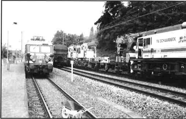
Déraillement d'une rame de minéral à Genval, suite au bris d'un bandage (photos Michel Marin, 02-09-2007).
